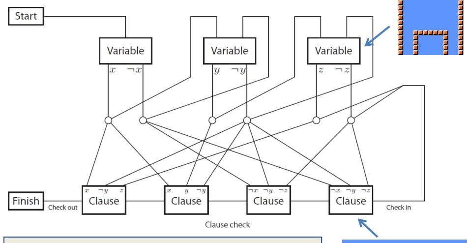
$(x \text{ OR } \neg y \text{ OR } z) \& (x \text{ OR } y \text{ OR } \neg y) \&$  $(\neg x \text{ OR } \neg y \text{ OR } \neg z) \& (\neg x \text{ OR } \neg y \text{ OR } \neg z)$
