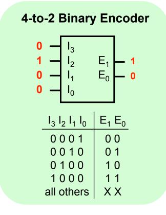
module binary\_encoder(i, e); input [3:0] i; output [1:0] e; reg e;
